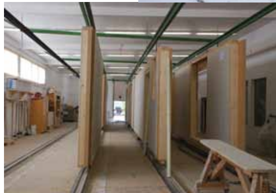
■ Fot. 5. Prefabrykacja ścian wykonanych z surowca drzewnego
